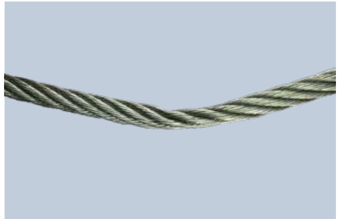
Figura 4: Cabo de aço amassado
