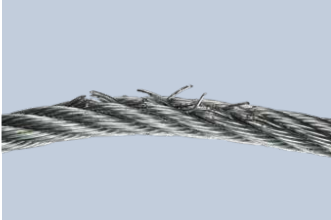
Figura 4: Arames rompidos devido ao desgaste
