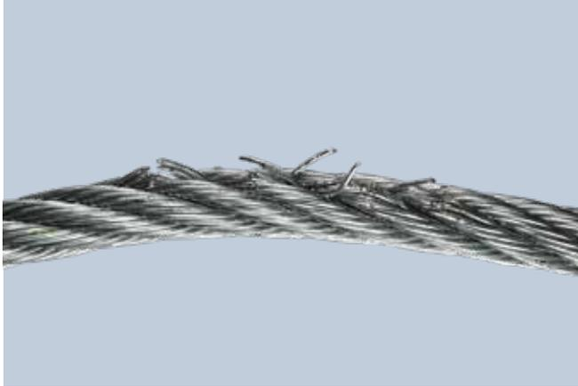
Figura 4: Arames rompidos devido ao desgaste
