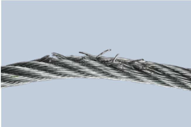
Figura 4: Arames rompidos devido ao desgaste
