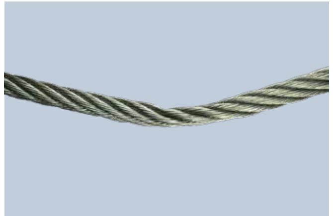
Figura 4: Cabo de aço amassado
